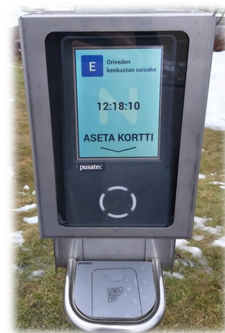
KUVA: Uudet lipunkortinlukijat, jotka mahdollistavat NYSSE-kortin käyttämisen maksuvälineenä junassa.
